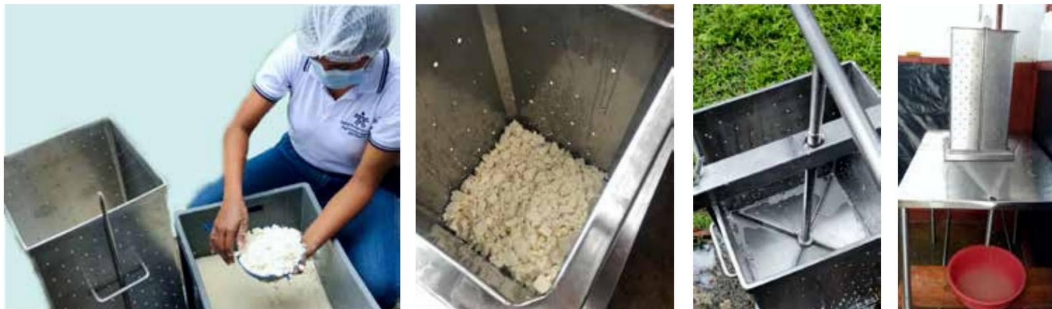
Dos de los moldes sugeridos para el proceso de quesería rural son, a) el de plástico en polipropileno o en teflón, y b) el de acero inoxidable con prensa Individual de tornillo
